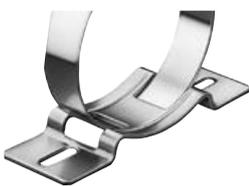
Die NORMACLAMP® HMK K1 sind vorgefertigte Konsolen, mit denen Sie NORMACLAMP® Standardschellen (Typen GBS, HD, SP und TORRO) im Handumdrehen in Halterungsschellen mit Konsole umwandeln können. Öffnen Sie einfach die Standardschelle und führen Sie das Band durch den Konsolenschlitz, fertig.
